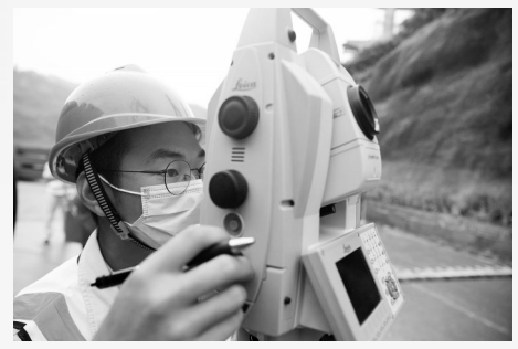
监测锚碇、危岩位移情况。 张玉恒 摄
